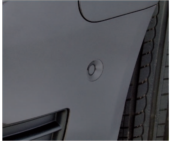
Einbauort des Ultraschallsensors für Parklenkassistent seitlich links
