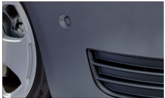
Einbauort des Ultraschallsensors für Parklenkassistent seitlich rechts
